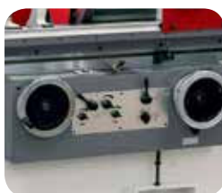
Painel de Controle dos Avanços
