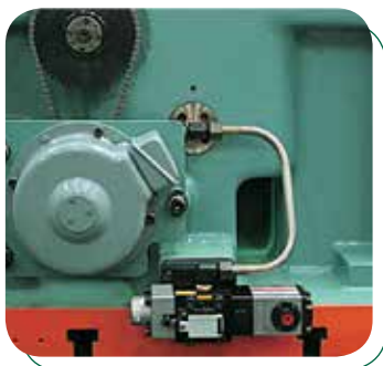
Ajuste motorizado da altura do martelo (a partir de 60 ton.)
