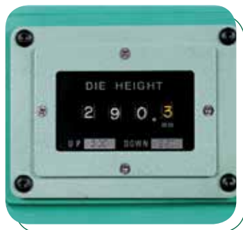
Indicador de altura da ferramenta com precisão decimal
