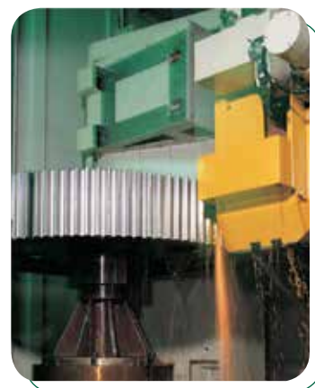
Engrenagem principal tratada e retificada
